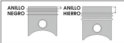
En los motores modernos un menor espesor axial en los anillos de acero permite posicionar estos mucho más cerca de la cabeza del pistón y de este modo se logra así alcanzar una disminución en la emisión de gases residuales.
