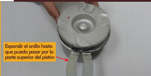
Si expande el anillo horizontalmente con una herramienta, podrá evitar la deformación y así instalar el anillo con seguridad
