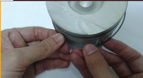
Luego enrolle el resorte en espiral en la tercera ranura y cierre el círculo. Es importante insertar la juntura hasta que los dos extremos del resorte se toquen.
