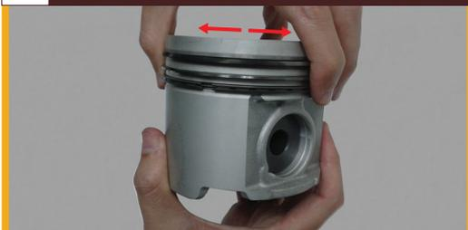
La deformación vertical (torción) de los anillos y el traslape de las puntas del espaciador, impiden el giro de los anillos.
