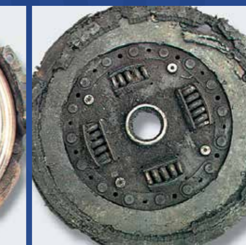
BALATA DE DISCO DAÑADA
