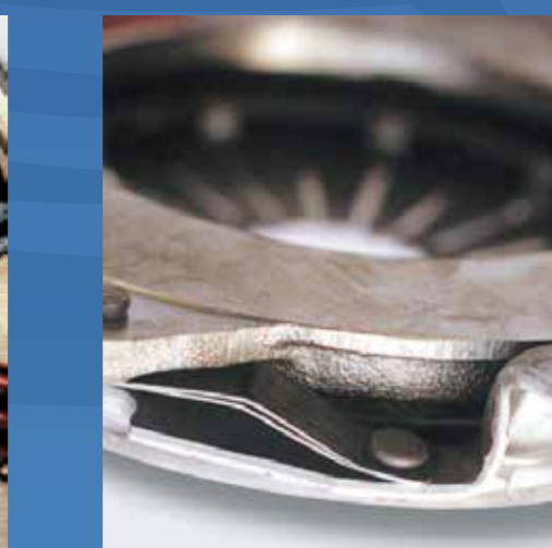
LAINAS DE PRENSA DE EMBRAGUE DAÑADAS
