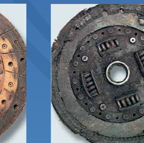
BALATA DE DISCO DAÑADA
