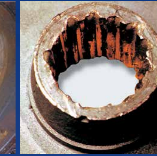
ESTRÍAS DEL NÚCLEO DE DISCO DE EMBRAGUE DAÑADAS
