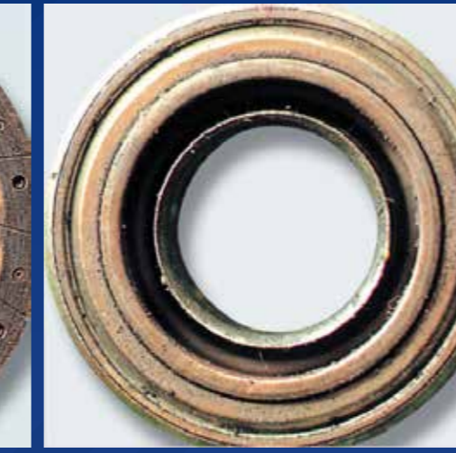
RODAMIENTO DE EMPUJE DAÑADO
