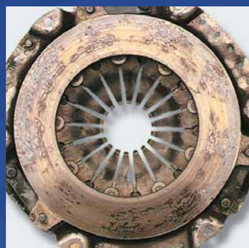
MARCAS DE QUEMADURAS EN EL PLATO DE LA PRENSA
