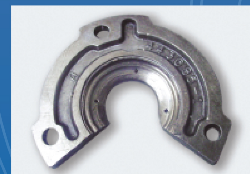
Desgaste de las rampas de lubricación debido a la fricción con el collar.
