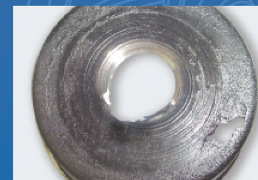
Protección térmica dañada por la fricción con el rotor de la turbina causado por el empuje axial (exceso de humo).
