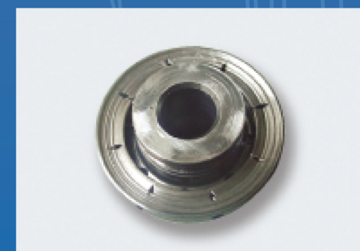
Desgaste por causa del rozamiento entre el collar y el frente del plato.
