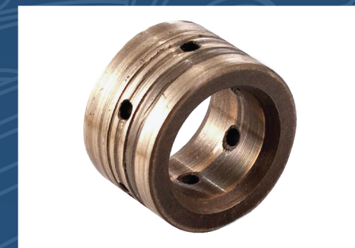
Bujes radiales dañados.
