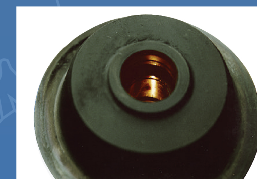
Restos de aceite carbonizado obstruyen el sistema de sellos provocando fuga de aceite.
