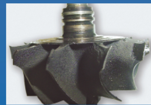
Ejemplo de empuje axial en sentido del compresor de turbina.
