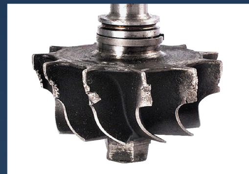
Roce del rotor de la turbina.
