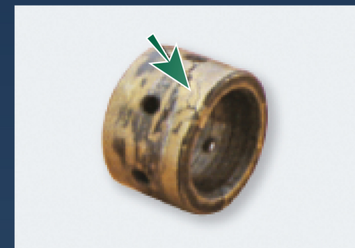
Buje radial con ralladura debido al sobrecalentamiento.
