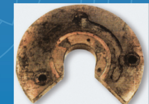
Bujes de apoyo con el depósito de aceite carbonizado (alta temperatura o mala calidad del aceite).
