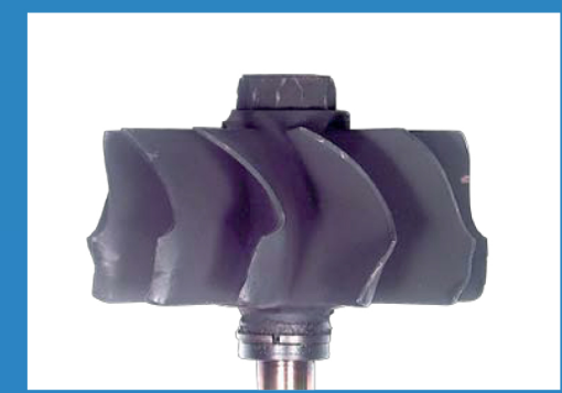
Rotor de la turbina dañado por un objeto extraño.
