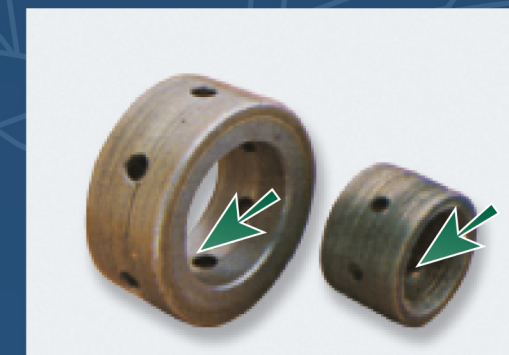
Puede dañar el diámetro interno de los bujes.
