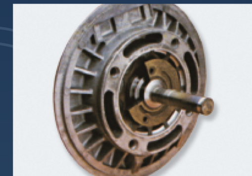
Rotura del eje.
