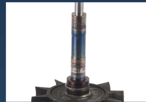
Manchas moradas o azules en el eje, debido a altas temperaturas.
