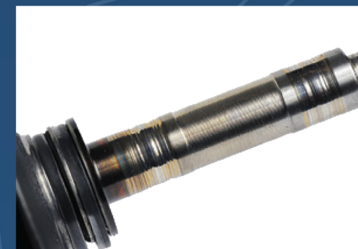
Ralladuras profundas en los descansos de los bujes.
