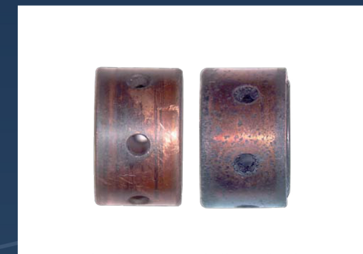
Buje radial con los agujeros de paso de aceite obstruido.
